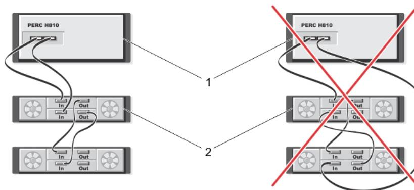
Abbildung 4. Konfiguration für die Unterstützung redundanter Pfade für zwei Gehäuse
