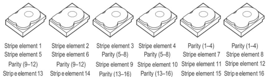
Abbildung 9. Beispiel doppelt verteilter Parität (RAID 6)
