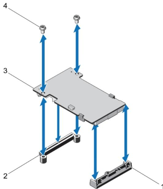
**Abbildung 2. Entfernen und Installieren des PERC Mini Blade-Controllers**
