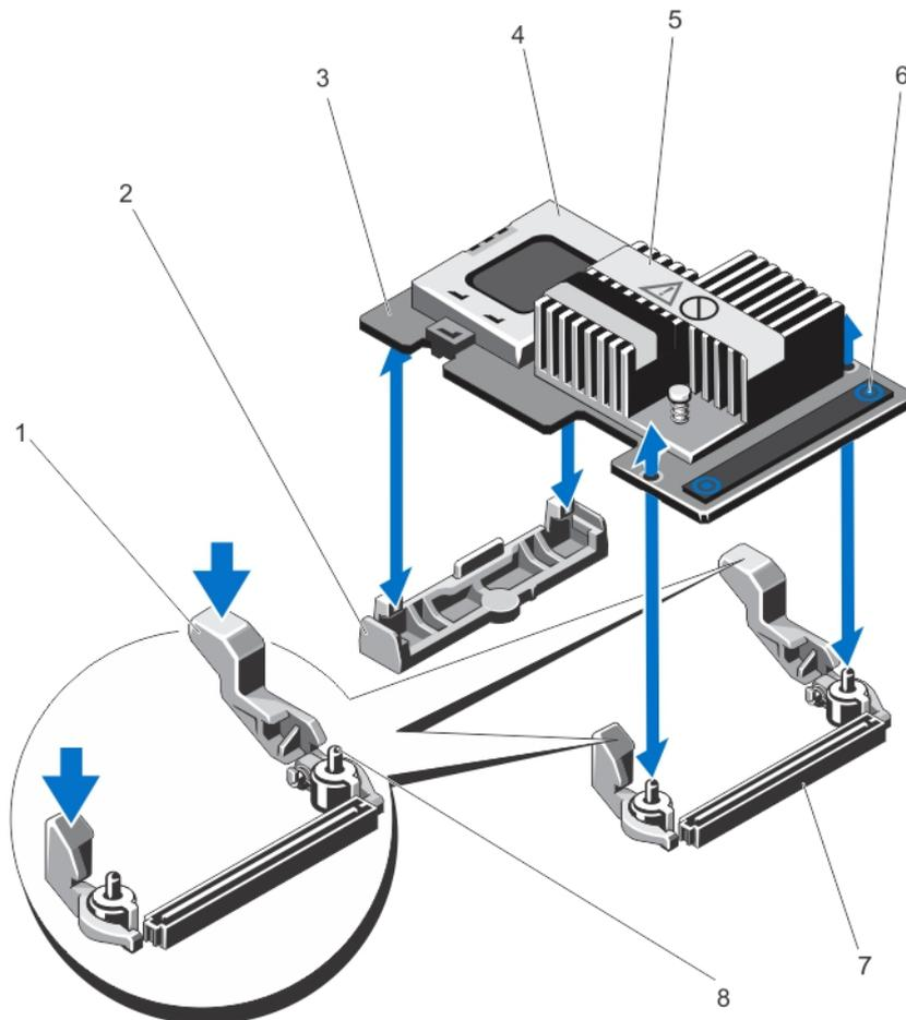
**Abbildung 3. Entfernen und Installieren des PERC Mini Monolithic-Controllers**
